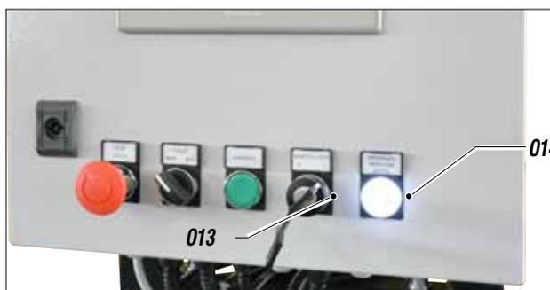
**SPIA TENSIONE INSERITA 24 VDC (014):** Indica la presenza della tensione ausiliaria che alimenta tutte le utenze a 24 VDC compreso PLC
