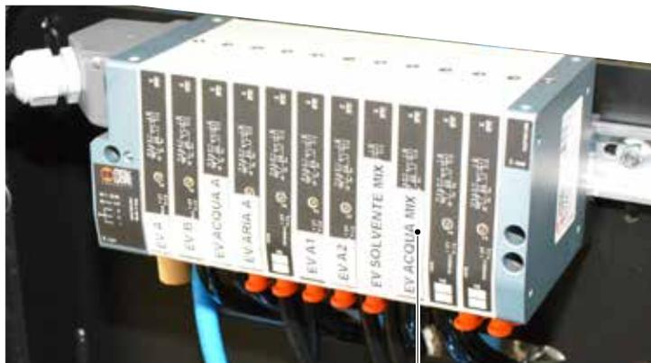
In casi estremi dovuti alla mancanza di energia elettrica prolungata, potrebbe essere necessario eseguire una manovra meccanica al fine di garantire l'attivazione della valvola denominata **EVACQUA MIX** per permettere il lavaggio del prodotto catalizzato contenuto nel miscelatore e nel tubo che va alla pistola di verniciatura che altrimenti non si potrebbe lavare operando con la procedura standard di attivazione del lavaggio dal quadro elettrico.
