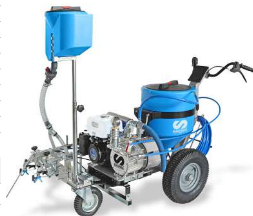
Cod. LA18382/1 Macchina traccialinee airless DALÌ PLUS con kit distributore perline per ottenere l'effetto catarifrangente
