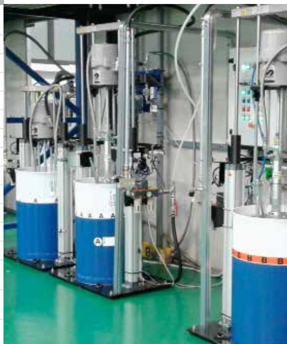
Centrale di alimentazione per silicone con sistema Stand-by
