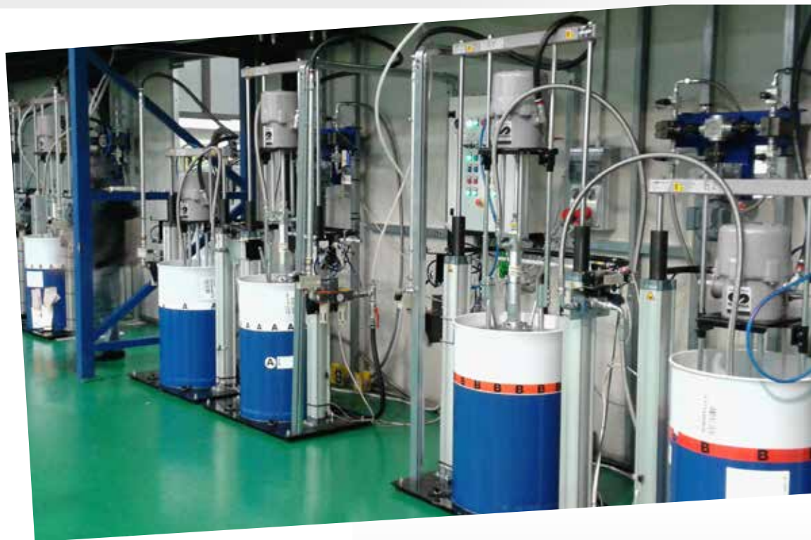
Centralized silicone supply, with automatic drum change. Centrale di alimentazione per silicone con dispositivo Stand-by.
